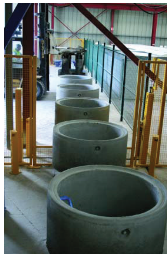
Передача на выходной транспортер. Бетонные элементы покидают производственный цех в следующую рабочую смену
