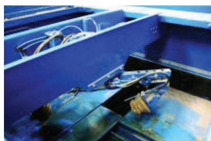
Губки для смазки поддонов эффективно наносят смазку
