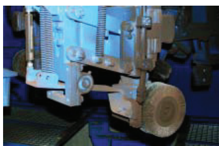
Стальные щетки снимают остатки бетона с поддонов
