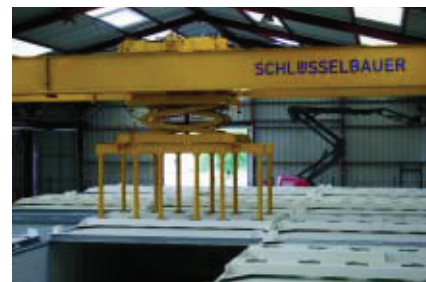
За счет вращения захватов возможно перемещение крышек сушильных камер без замены инструмента
