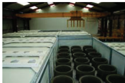
Шахтные кольца после сушки перед транспортировкой краном-роботом
